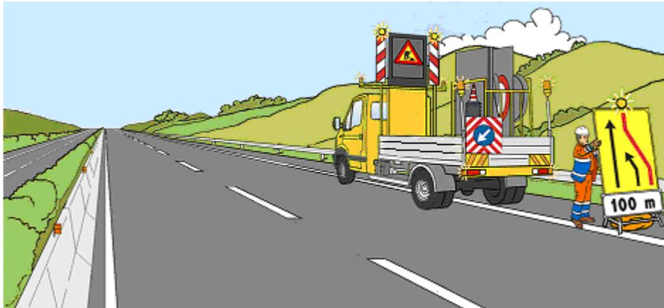
**Figura 47 – Chiusura della corsia di marcia: installazione del segnale di esclusione della corsia sul margine destro**
