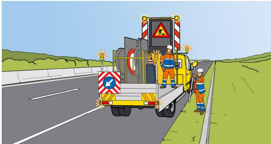
**Figura 34 – Chiusura della corsia di sorpasso: scarico delle lampade blitz sul margine destro**
