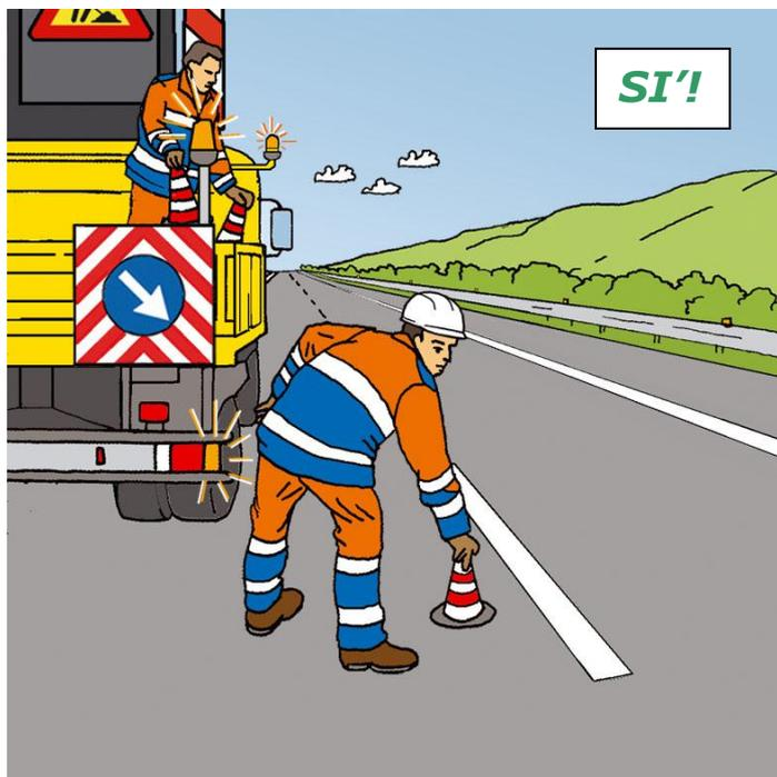
**Figura 59 – Posizionamento dei coni o defleco: comportamento corretto**
