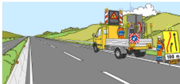
**Figura 54 – Chiusura della corsia di sorpasso: installazione del segnale di esclusione della corsia sul margine destro**
