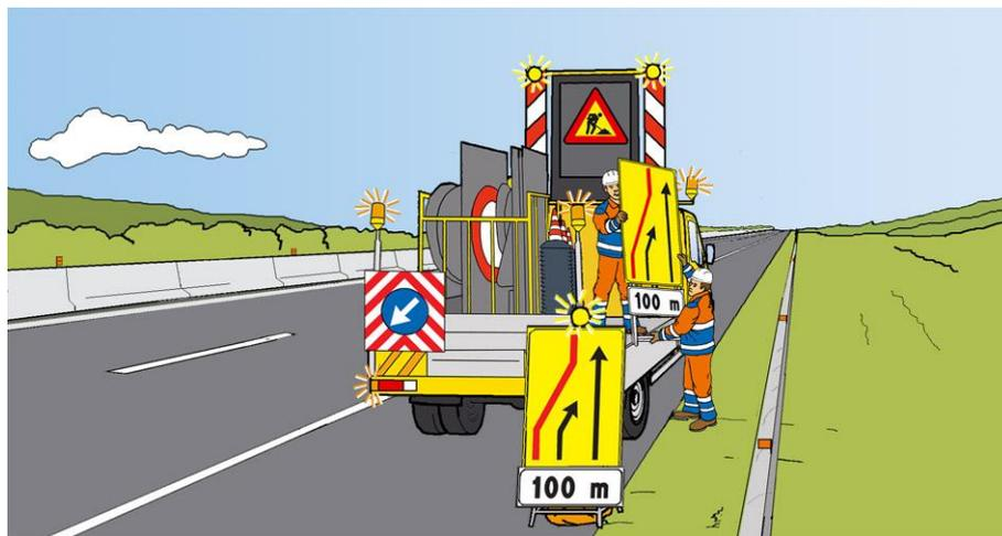
**Figura 38 – chiusura della corsia di sorpasso: scarico ed installazione del segnale di esclusione della corsia sul margine destro**
