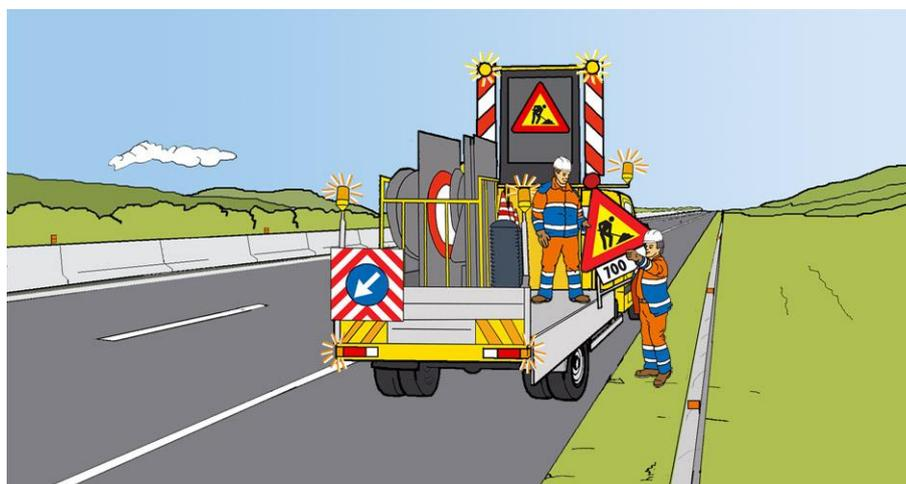
**Figura 36 – Chiusura della corsia di sorpasso: scarico ed installazione del segnale di lavori in corso sul margine destro**
