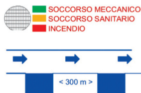
COLONNINE S.O.S. ogni 300 metri Impianto fonico con selezione di soccorso
